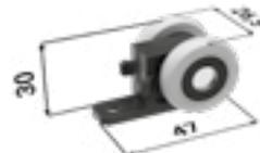
Набор креплений для стеклянного дверного полотна Vetro 22 с направляющим флажком
