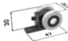
Набор креплений для стеклянного дверного полотна Vetro 22 с направляющим флажком
